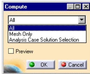
L'option *Preview* permet d'avoir une estimation du temps et de la mémoire nécessaire pour le calcul. Lorsque les calculs sont finis, le maillage est visible sur la pièce et les branches de l'arbre sont mises à jour. Le post-traitement peut alors commencer. Le tableau ci-dessous résume les différentes possibilités :
